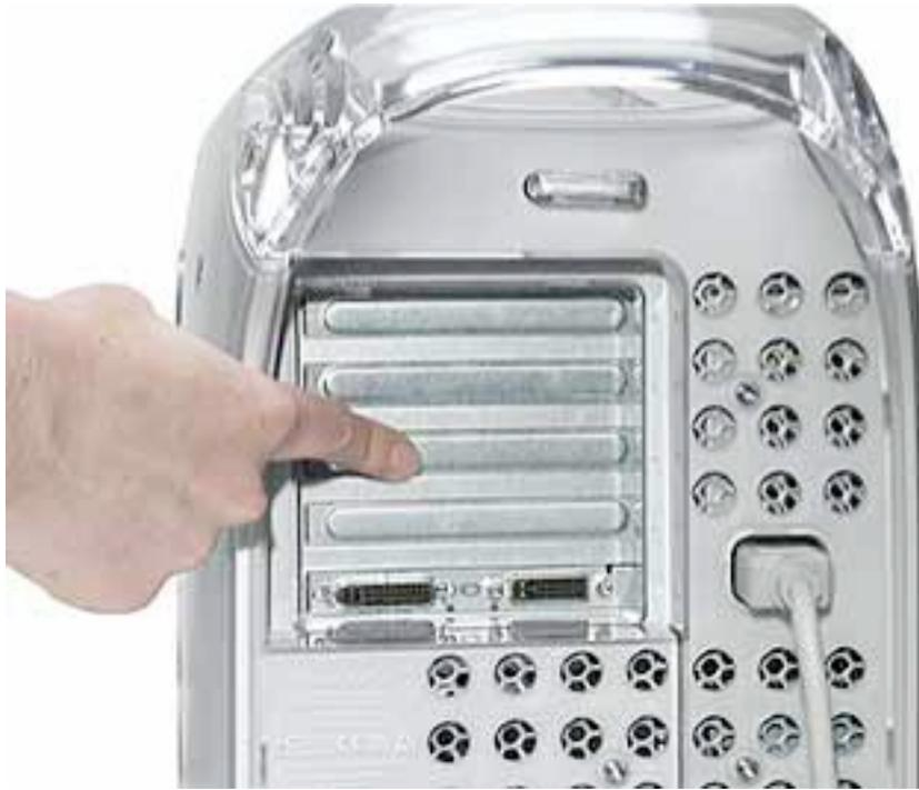
**【重要】** コンピュータ内部の部品に触れたり部品を取り付けたりする前に、必ずコンピュータ内部の金属部分に触れて静電気を除去してください。また、静電気の発生を防ぐため、メモリ取り付けの作業を終えてカバーを閉じるまでは部屋の中を歩き回らないでください。
