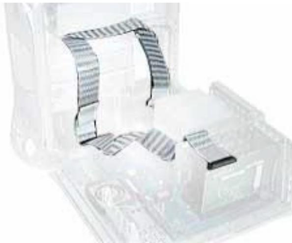
**【参考】** ハードディスク側の SCSI ケーブルを外すには、キャリアをシャーシに固定するためのネジをプラスドライバーで外し、キャリアレバーを手前に引きながらキャリアを上をスライドさせてシャーシからキャリアを外します。(図4)
