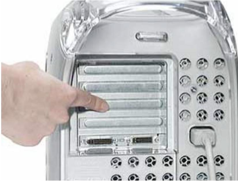
**【重要】** コンピュータ内部の部品に触れたり部品を取り付けたりする前に、必ずコンピュータ内部の金属部分に触れて静電気を除去してください。また、静電気の発生を防ぐため、メモリ取り付けの作業を終えてカバーを閉じるまでは部屋の中を歩き回らないでください。
