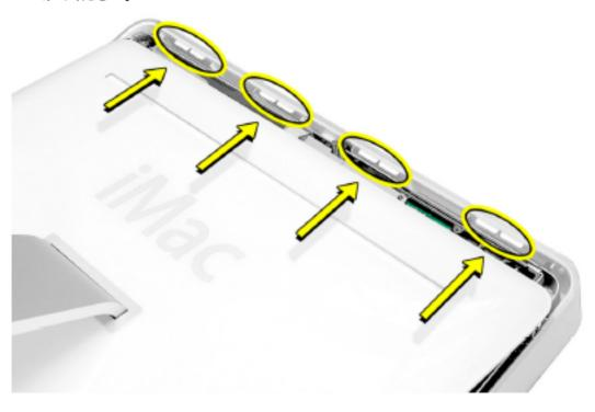
2. 背面カバーを少し傾けて、上端をケースのツメに揃えます。両方を合わせながら背面カバーを押し下げます。
