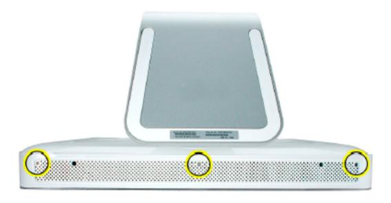
6. 金属製の脚を持って、背面カバーを上方に傾けるように持ち上げて手前に引きながら コンピュータから外します。
