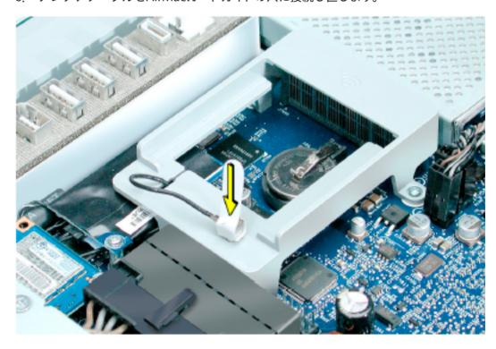
7. 鉛筆かプラスチック製のツールを使って、バッテリを矢印方向に押して、バッテリを 金属製のクリップから取り外します。
