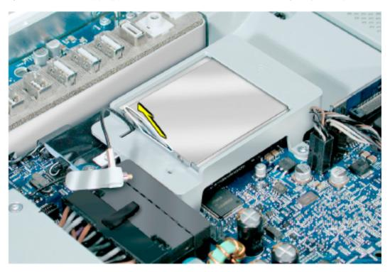
6. アンテナケーブルをAirMacカードガイドの穴に接続し直します。
