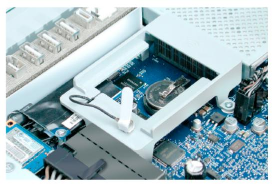
4. AirMac ExtremeカードをAirMacカードガイドのスロットにカチッと収まるまで挿入します。AirMacアンテナケーブルをAirMac Extremeカードに接続します。
