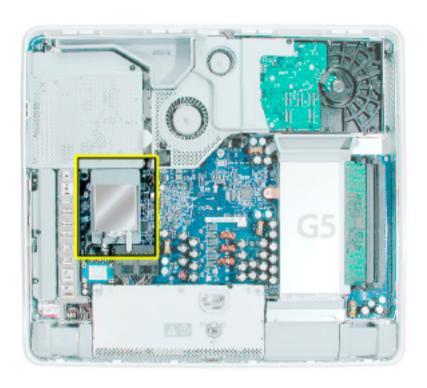
4. アンテナケーブルを、取り付けられているAirMac Extremeカードの端から取り外します。
