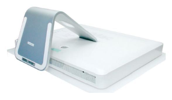
4. 下の図で丸印のついた3つのケース用ネジを探します。中央のケース用ネジは、金属製の脚を持ち上げないと見えないことがあります。
