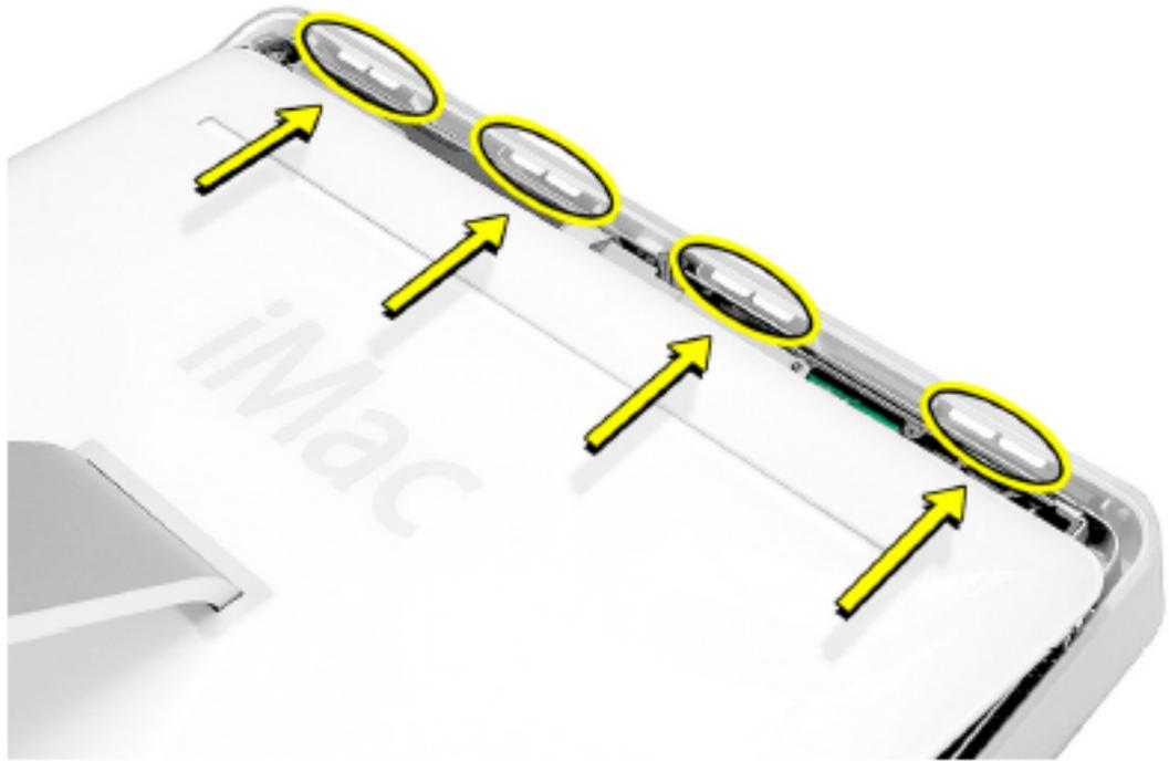
2. 背面カバーを少し傾けて、上端をケースのツメに揃えます。両方を合わせながら背面カバーを押し下げます。
