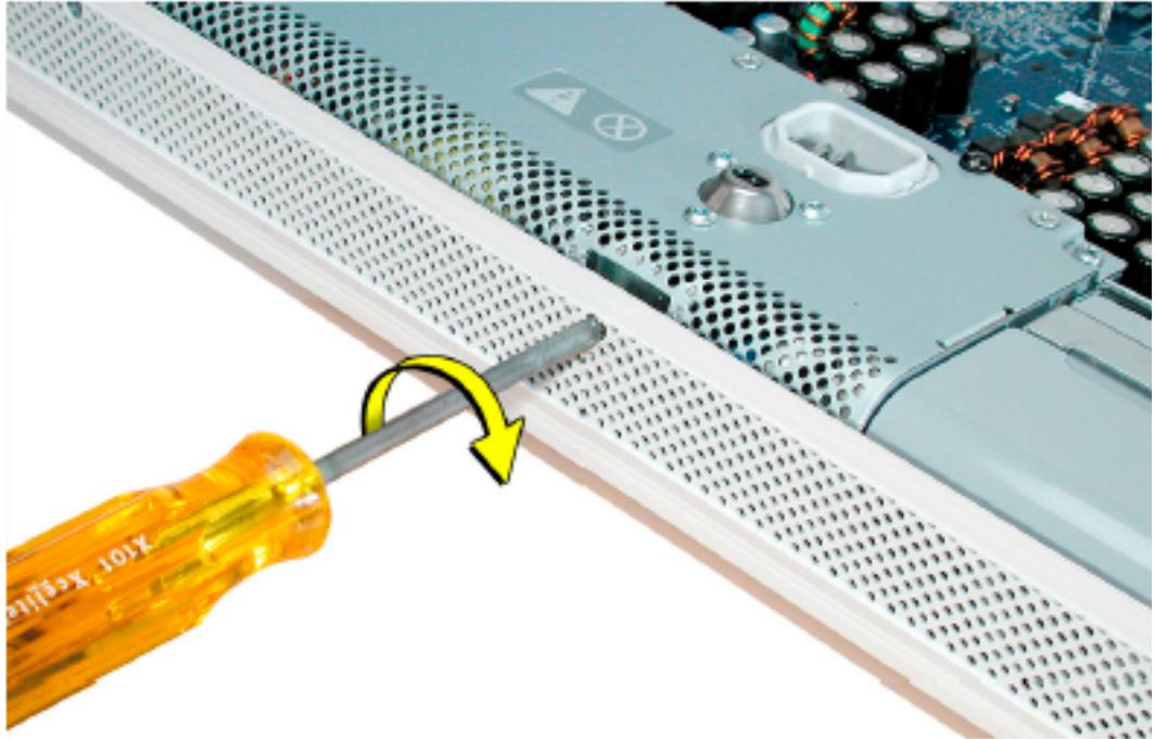
5. コネクタのリリースタブを押しながら幅の広いマイナスドライバーを使ってコネクタを左右均等にこじ開けるようにして電源ケーブルを取り外します。
