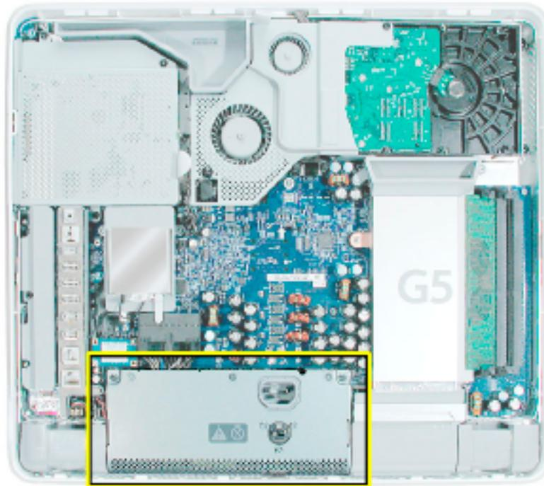
3. (下の図で丸印のついた)3つの電源用の保持ネジを反時計回りに5~8回転ほど回して緩めます。ネジは保持ネジです。電源から取り外すことはできません。
