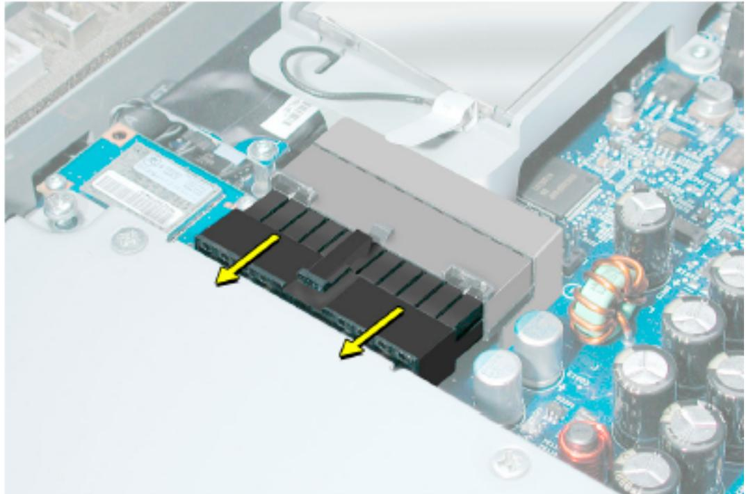
7. 電源がロジックボードの端から離れるまで上に傾けます。コンピュータから引き上げて脇に置いておきます。
