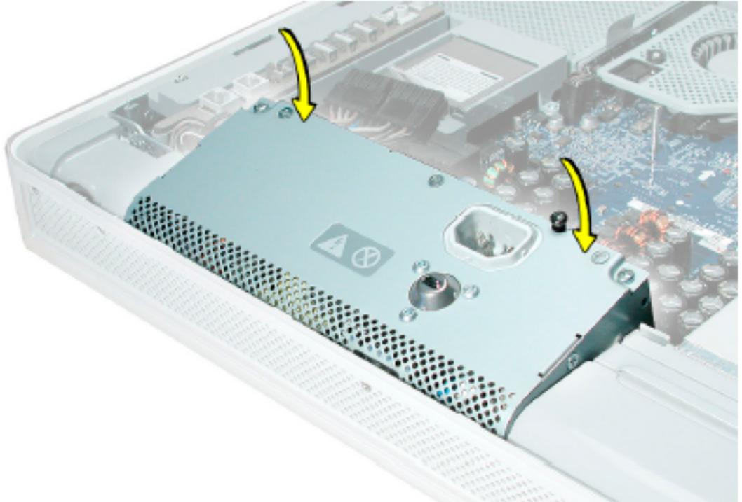
3. 黒い電源コネクタを接続して、3つの保持ネジを時計回りに締めます。
