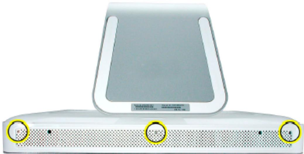
6. 脚を持って、背面カバーを上方に傾けるように持ち上げて手前に引きながらコンピュータから外します。
