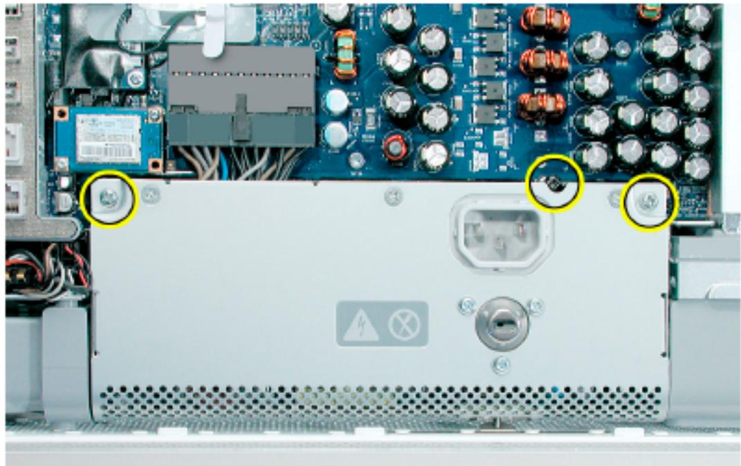
4. 中央のケース用ネジを5回転ほど時計回りに回します。これで電源をディスプレイ/ベゼルアセンブリに固定しているネジ留めが解除されます。
