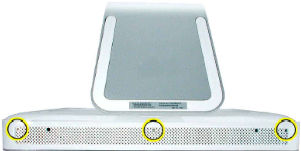
6. 背面カバーの金属スタンドを持って、カバーを上方に傾けるように持ち上げて手前に引きながらコンピュータから外します。
