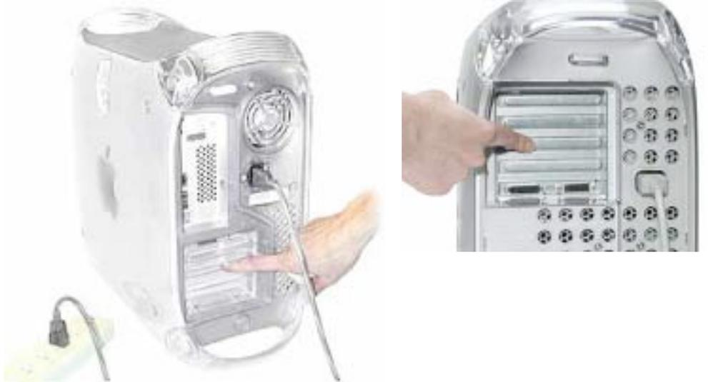
**【重要】** コンピュータ内部の部品に触れたり部品を取り付けたりする前に、必ずコンピュータ内部の金属部分に触れて静電気を除去してください。また、静電気の発生を防ぐため、メモリ取り付けの作業を終えてカバーを閉じるまでは部屋の中を歩き回らないでください。
