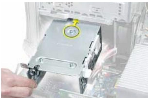
2. サイドアクセスパネルを閉じる前に、P4、P5の電源ケーブルコネクタがドライブに接続されていること、ドライブキャリア内にケーブルが収容されていることを確認して下さい。(図10)
