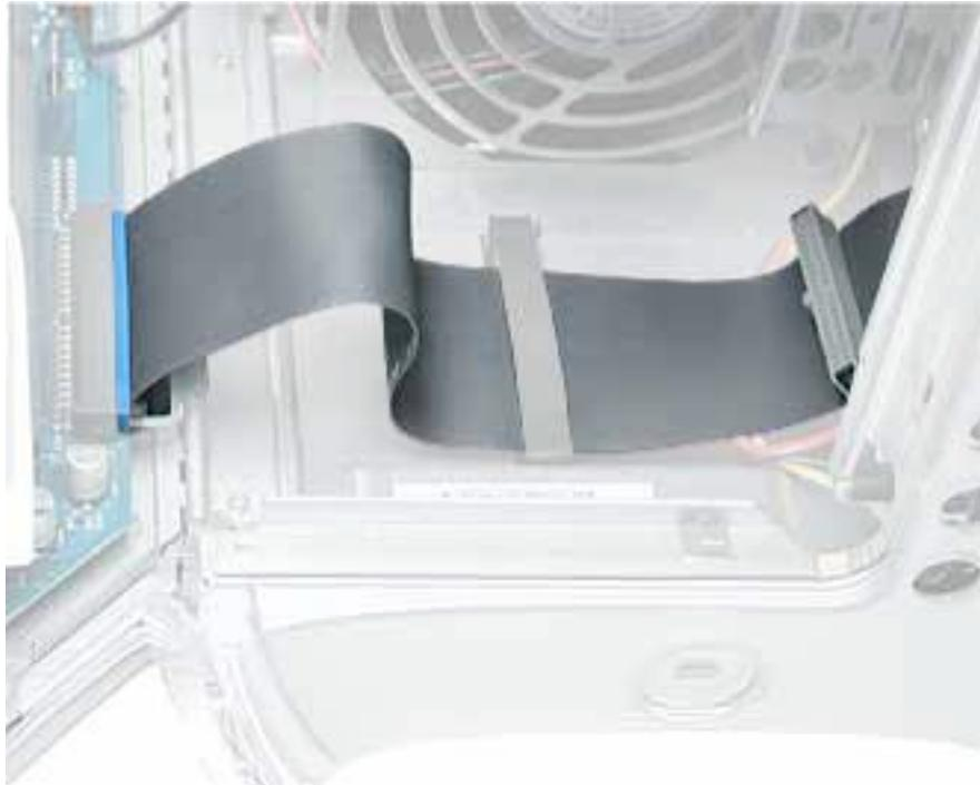
2. **【参考】** ハードディスク側の ATA ケーブルを外すには、キャリアをシャーシに固定するためのネジをプラスドライバーで外し、キャリアレバーを手前に引きながらキャリアを上をスライドさせてシャーシからキャリアを外します。(図3)
