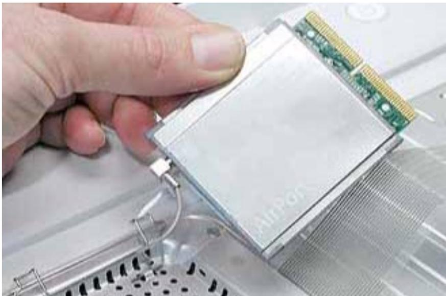
6. 交換用 AirMac Extreme カードをワイヤブラケットの下に挿入して、カードスロットの中にしっかりと取り付けます。
