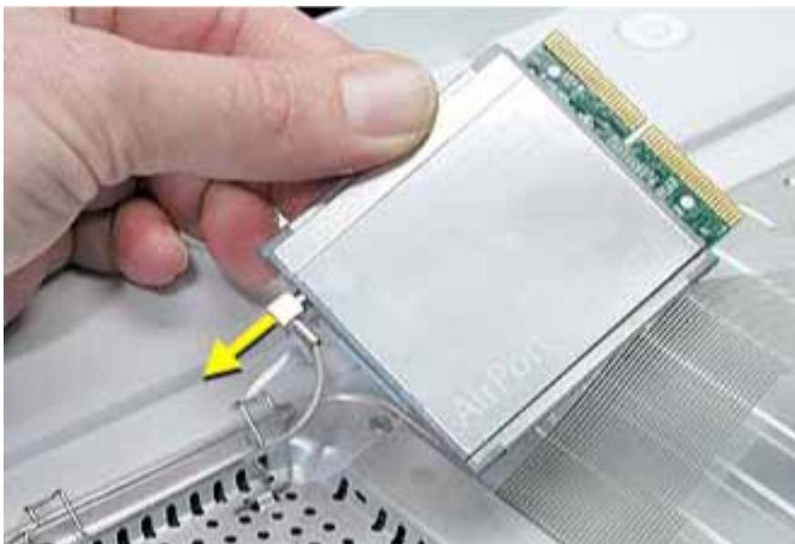
4. AirMac Extreme カードが取り付けられていない場合は、AirMac アンテナケーブルを解放するために、フレキシブルワイヤ・ホルダーの掛け金を外します。(図8)
