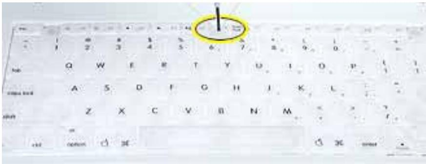
8. キーボードリリースタブ（F1とF12キーの左側に在る）（図3）を引き下げて、キーボードを解除して、キーボードのディスプレイ側をわずかに持ち上げます。
